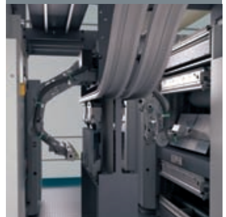
Il sistema permette un processo di cambio lastre automatico. Con APL logistics solo i cassette magazzino dovranno essere caricati manualmente.
